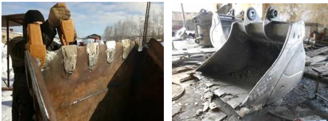
Рисунок 3 – Поломки зубьев ковша
