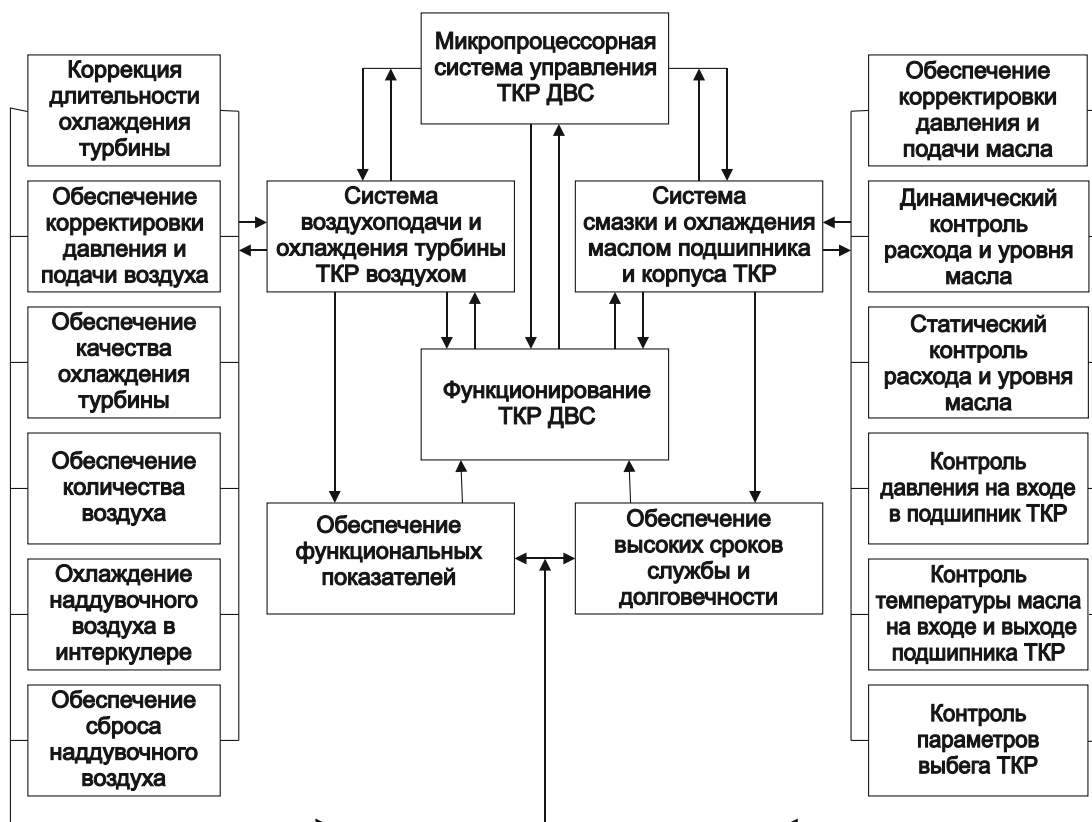
Рисунок 1 – Комплекс взаимосвязей при контроле технического состояния турбокомпрессора
