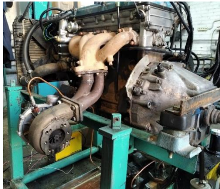
Рисунок 1 – Экспериментальный стенд на базе ДВС 3МЗ-4062 с системой газотурбинного наддува
