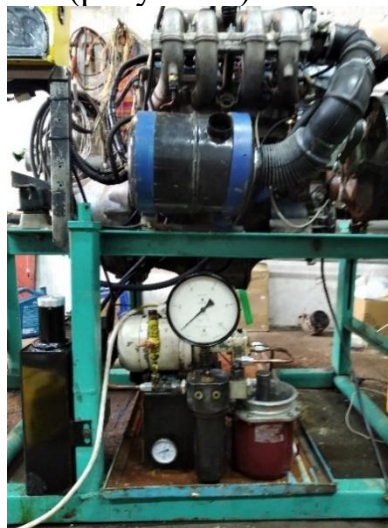
Рисунок 4 – Маслостанция, установленная под экспериментальным стендом
