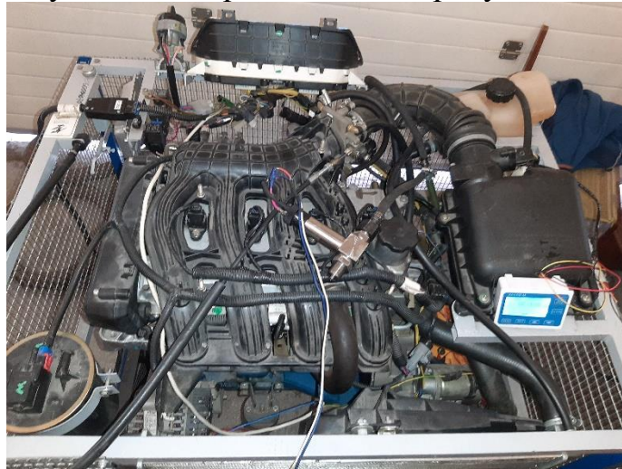
Рисунок 1 – Установка на базе двигателя автомобиля ВАЗ, управляемого ЭБУ Январь 7.2 Е2
