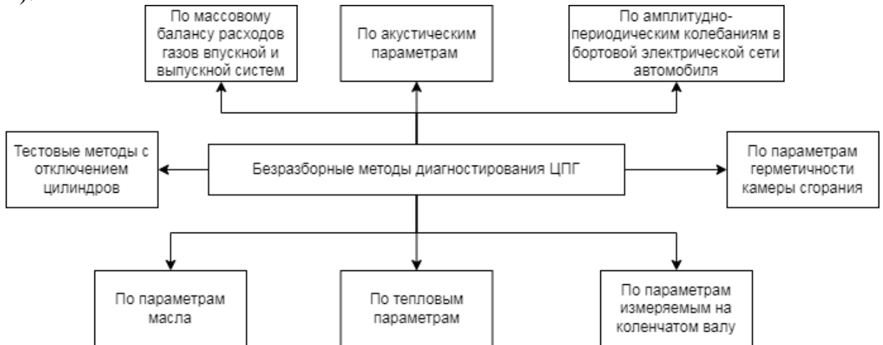
Рисунок 2 – Современные направления безразборных инструментальных методов диагностирования ЦПГ с помощью внешних устройств
