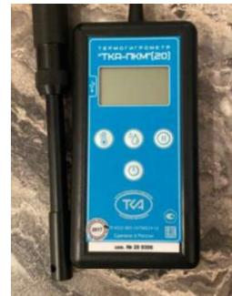
При помощи прибора, термогигрометр «ТКА-ПКМ» (20), на участке одновременно измеряли температуру на поверхности почвы и температуру, влажность на глубине 5-8 см. Датчик термогигрометра помещали в заранее пробуренный шурф того же диаметра что и датчик термогигрометра.
