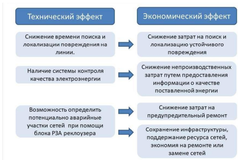
Рисунок 2 – Эффекты от использования реклоузера
