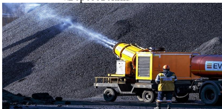
Рис. 4. Применение туманообразователей на Междуреченских разрезах
