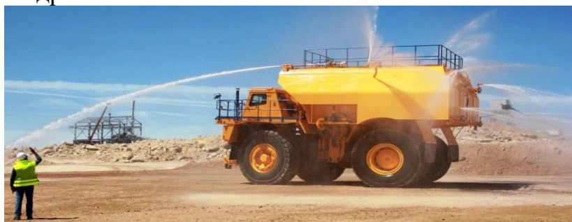
Рис. 1. Орошение взрывных блоков и их сейсмоопасных зон
