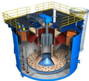
Рисунок 2. Принцип работы флотационной машины
