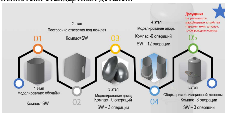
Рис. 2. Этапы создания модели ректификационной колонны в средах по компас и по Solidworks
