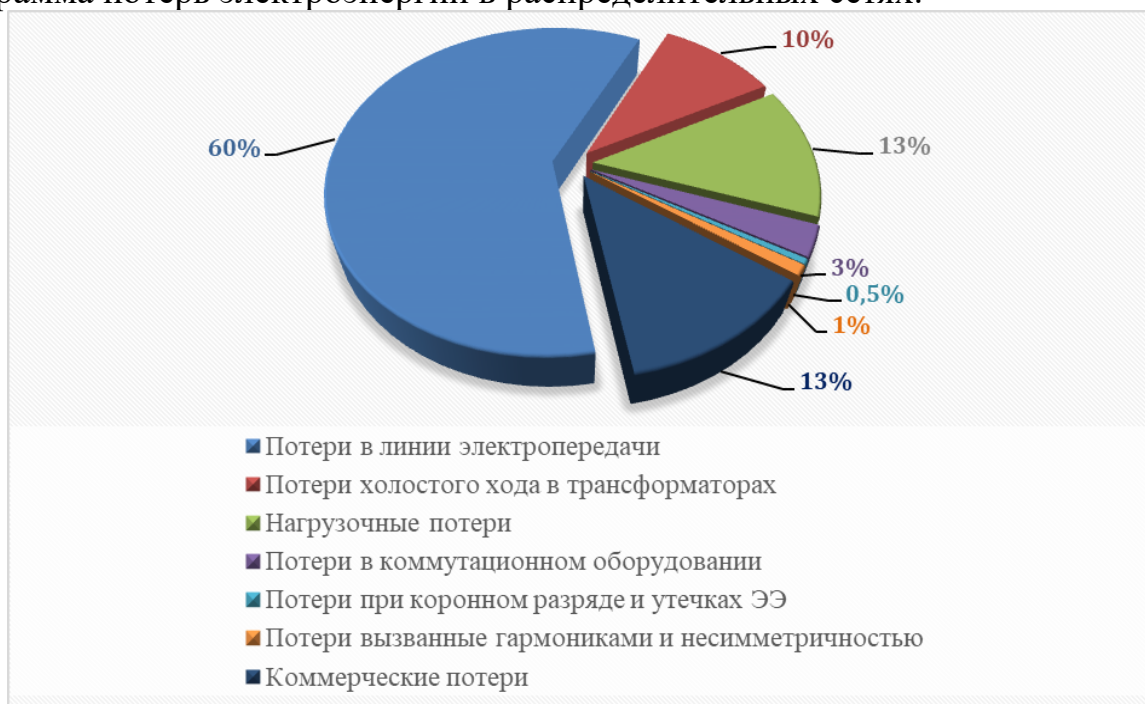
Рис. 2. Диаграмма потерь электроэнергии в распределительных сетях
