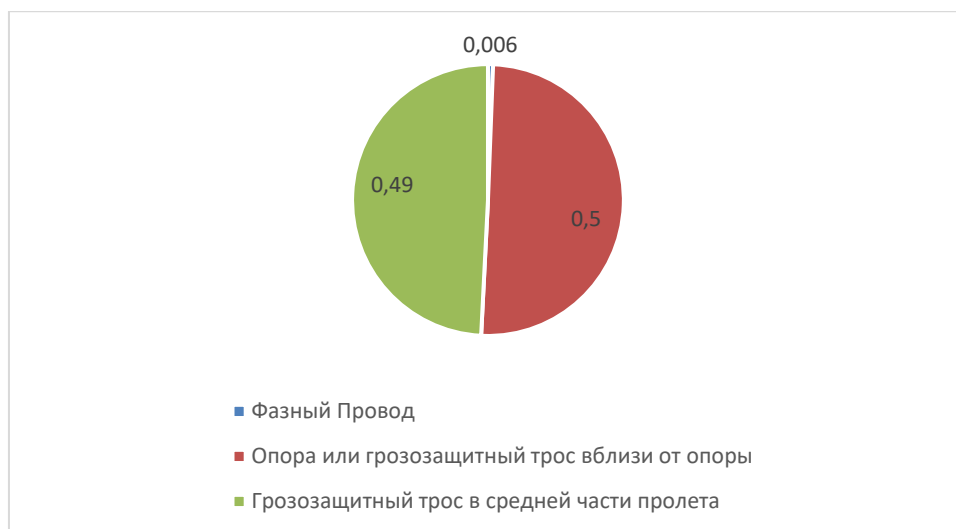
Рис. 3. Доля ударов молнии в различные части ВЛ. Грозозащитный трос есть
