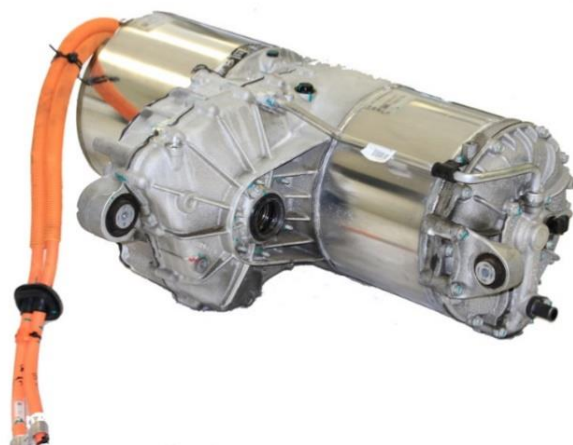
Рис. 1. Асинхронный тяговый двигатель Drive Unite электромобиля Tesla Model S [2].
