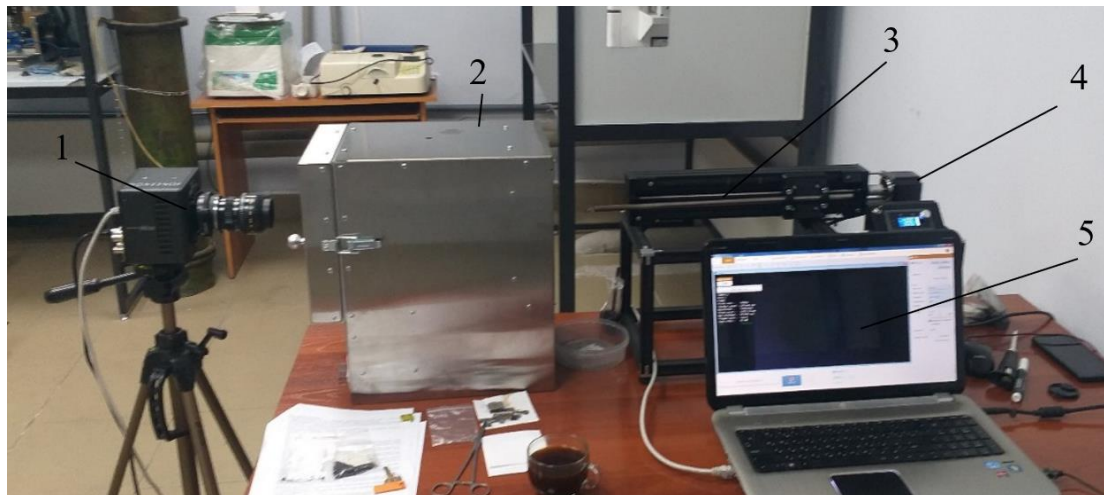
Рис. 1. Схема экспериментальной установки: 1 – высокоскоростная камера; 2 – камера сгорания (муфельная печь); 3 – платформа с держателем; 4 – шаговый двигатель; 5 – ПК для видео/фотофиксации
