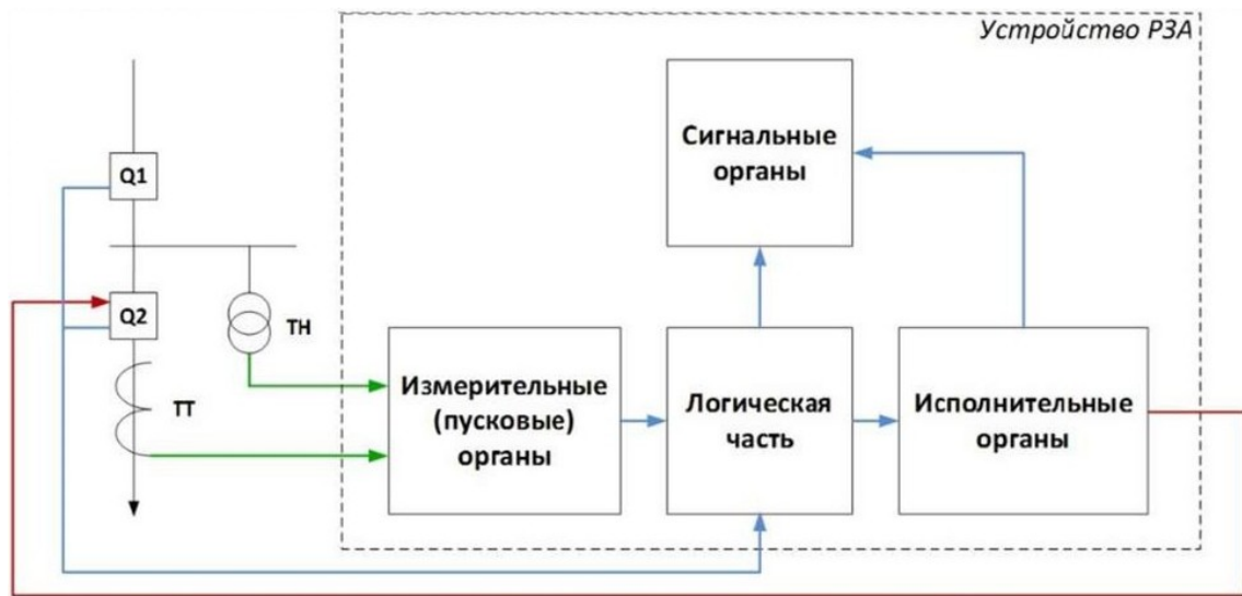
Рис.1. Структурная схема релейной защиты
