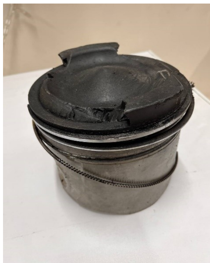
Рис. 1. Поршень, разрушенный в результате воздействия повышенной температуры
