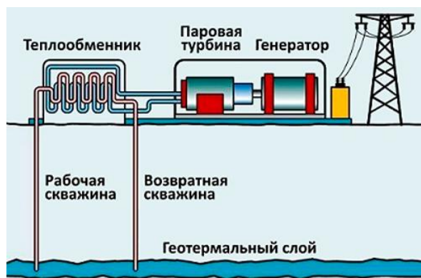
Рис. 6. Принцип работы ГеоТЭС
