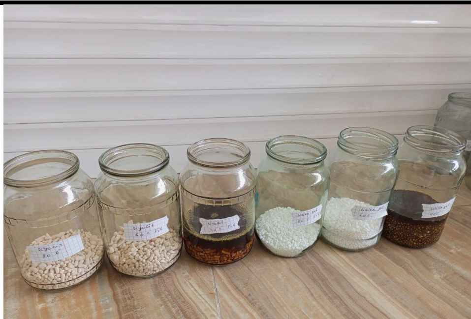
Рис. 2. Процесс очистки трансформаторного масла с использованием цеолита и силикагеля
