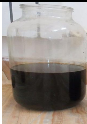
Рис. 1. Трансформаторное масло, пришедшее в негодность в результате внешних и внутренних воздействий.
