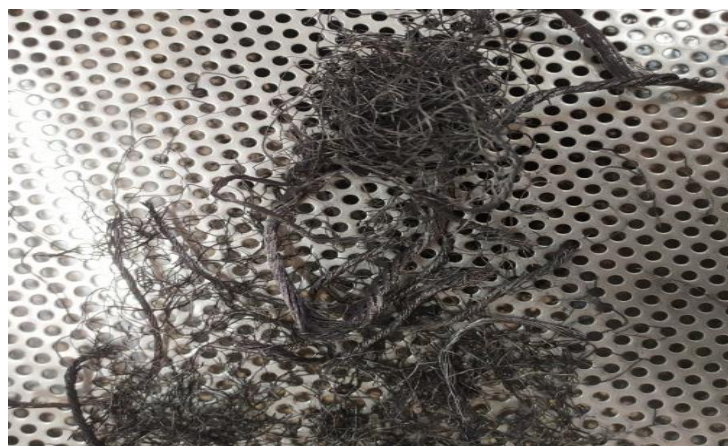
Рис. 2. – Металлический корд после процесса просева
