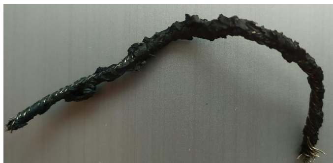
Рис.1. – Образцы металлического корда с вкраплениями резины (до пиролиза).
