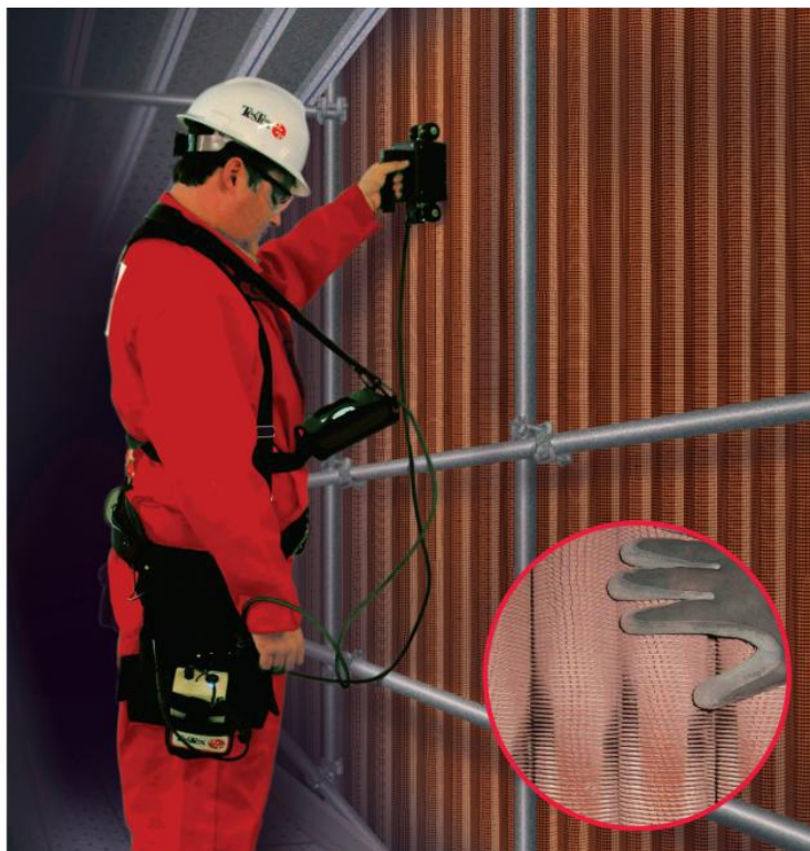
Рис. 1. Инспекция труб котла-утилизатора с внешней поверхности методом LFET [1]
