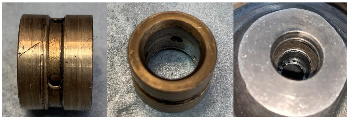
Рисунок 7 – Следы абразивного изнашивания турбокомпрессора ТКР2
