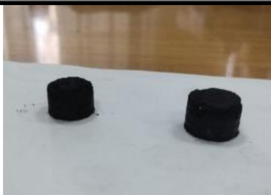
Рисунок 1. Результат прессования твердого остатка процесса ожижения углей с добавлением воды.
