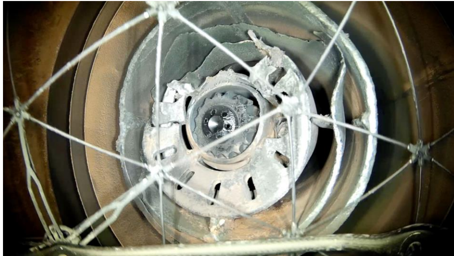
Рисунок 3 – Износ горелки, обнаруженный Elios 1
