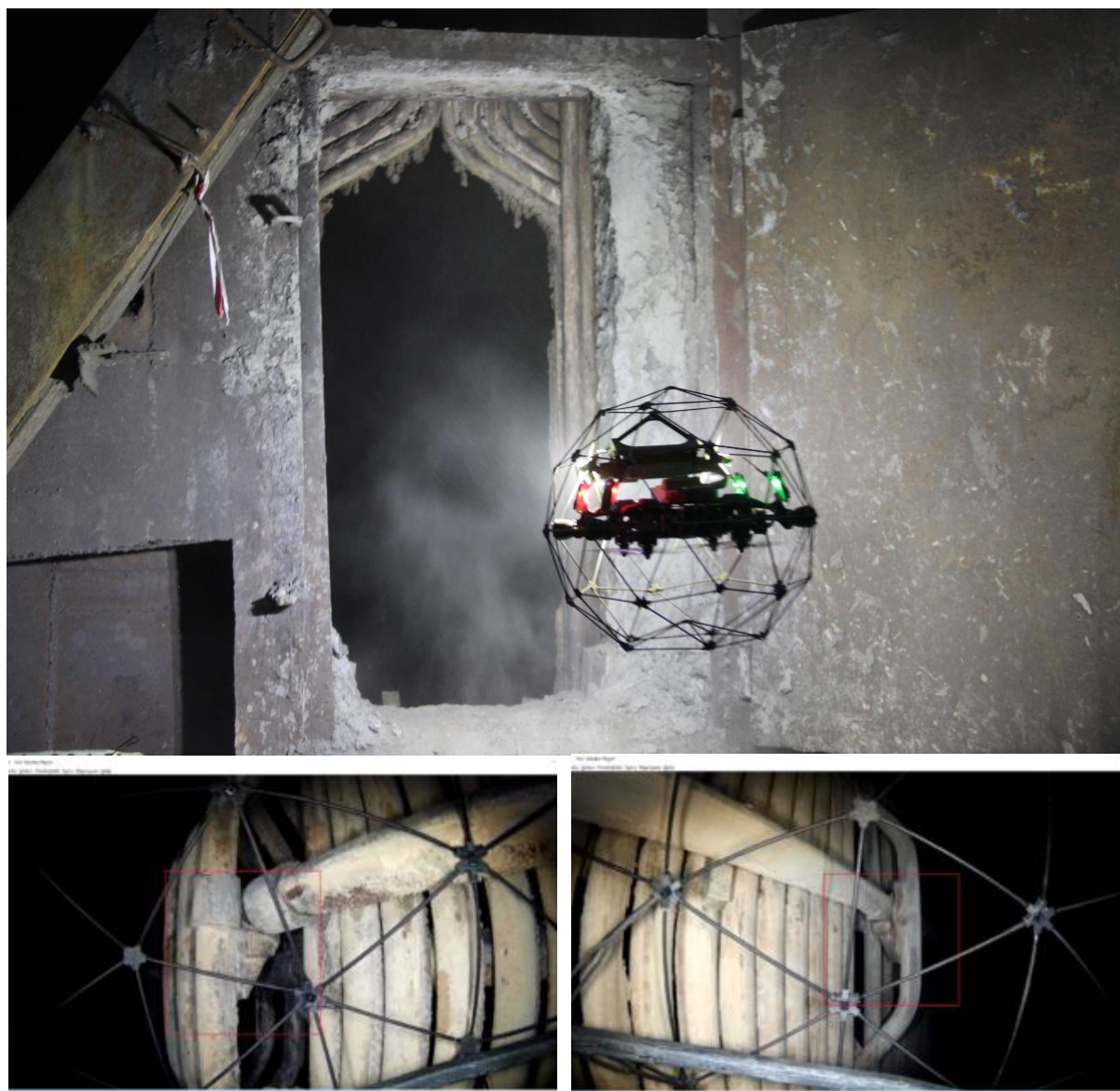
Рисунок 1 – Осмотр котла беспилотным летательным аппаратом Elios
