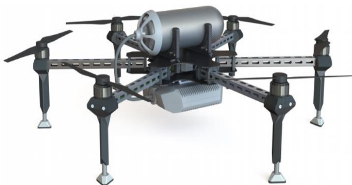
Рис. 2. БПЛА с гибридизацией суперконденсатора и топливных элементов
