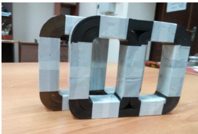
Рис. 1. Стержневая конструкция гибридного магнитопровода выпрямительного трансформатора
