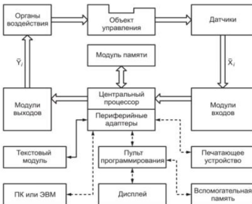
Рис. 1. Функциональный состав ПЛК
