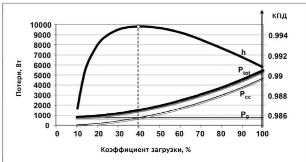
Рис. 1. Определение оптимальной загрузки силового трансформатора
