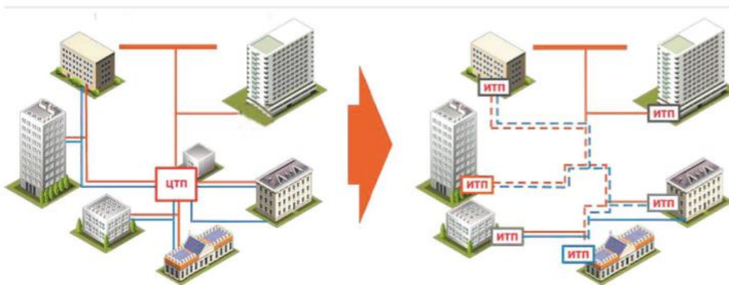
Рис.1. Изменение схемы распределения теплоносителя при ликвидации центральных тепловых пунктов
