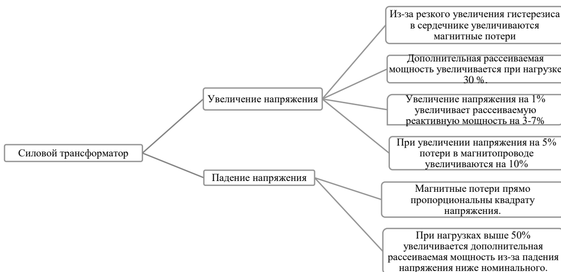
Рис.4. Дополнительный потер из–за отклонения напряжения в силовых трансформаторах
