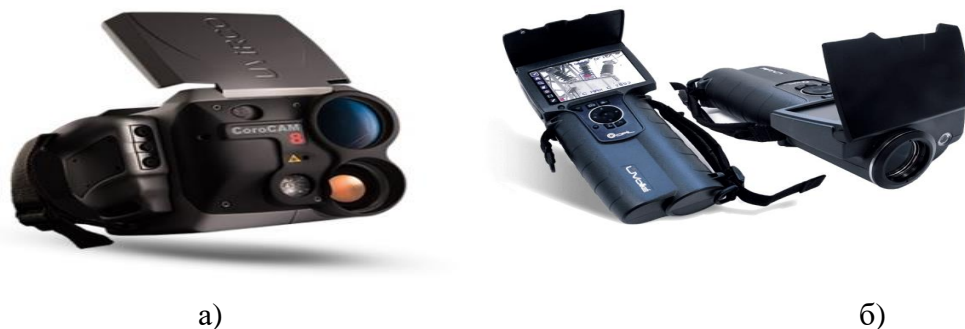
Figure. 2. UV flaw detectors a) CoroCAM 8; б) DayCorOfil
