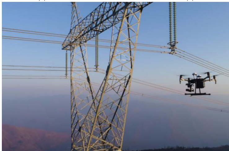
Рисунок 3 - Диагностика ВЛ квадрокоптером
