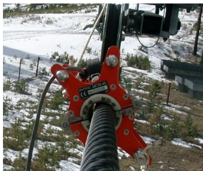
Рисунок 4 - Установка дефектоскопа ИНТРОС
