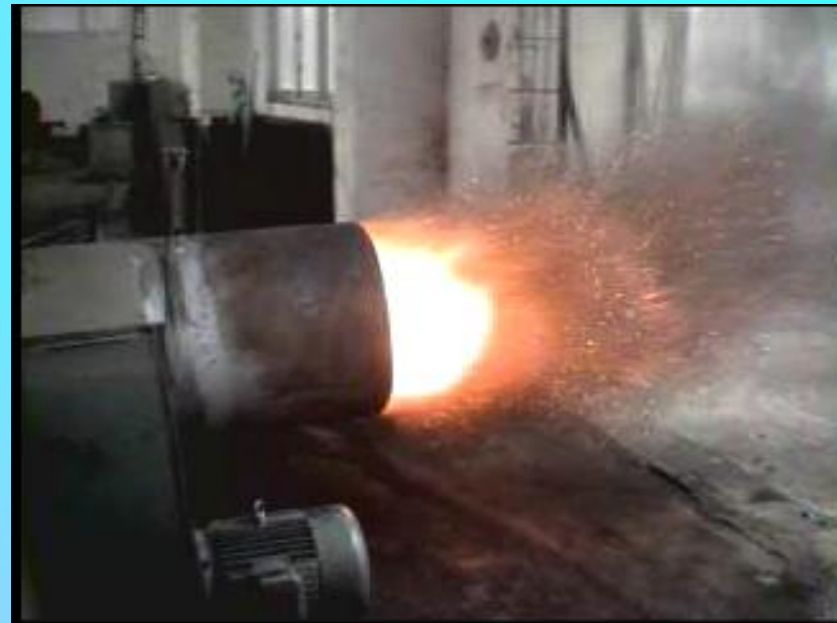
Система плазменного розжига в г. Лоян (Китай)
