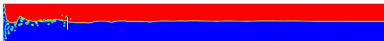
Рисунок 7. Объемная концентрация нефти в трубе при расположении перегородки x_0 = 0,1 м, \alpha = 90^\circ .
