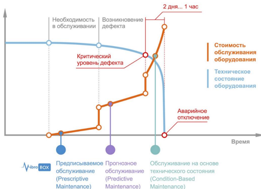
Рисунок - Типичные этапы деградации оборудования и технологии технического обслуживания.
