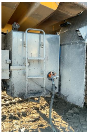
Рис.1. Система подачи топлива под давлением через клапан
