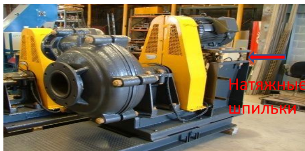
Рис. 8. Насос шламовый Warman 12/10 [13]
