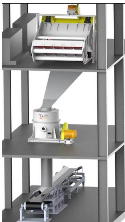
Рис. 3. Дегидрационный комплекс TAPP Group: высокочастотный грохот AURY ARHF 2436 и центрифуга ARML1200
