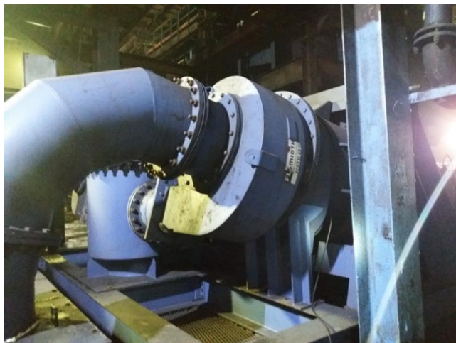
Рис. 2. Тяжелосредний гидроциклон диаметром 1000 мм для обогащения углей с крупностью кусков 1-100 мм на ЦОФ «Печорская»
