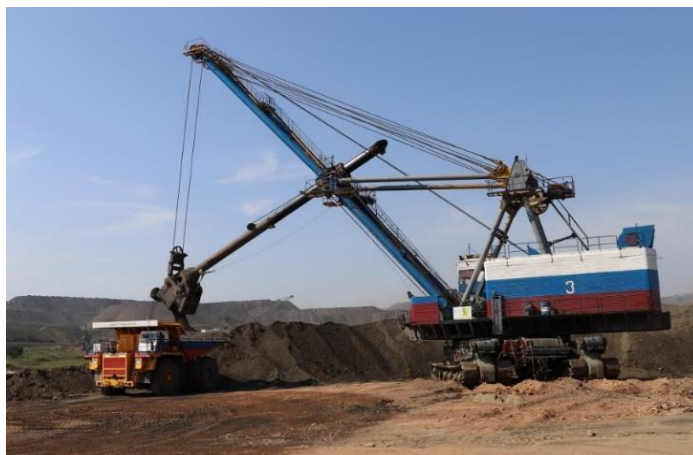
Рисунок 3 – Роботизированный карьерный самосвал БЕЛАЗ-7513R
