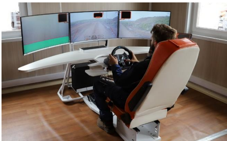
Рисунок 4 – Место работы оператора (дистанционное управление карьерным самосвал БЕЛАЗ-7513R)
