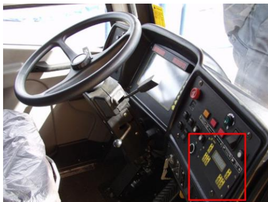
Рисунок 5 – Расположение блока управления-дисплея СКТ на БелАЗ 7555
