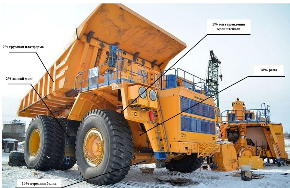
Рисунок 2 – Анализ образования трещин элементов КС
