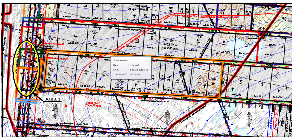
Рис. Прогнозный план деформированности горного массива по пласту 70
