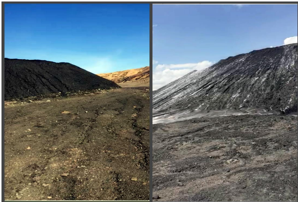
Рис. 2. Образование промоин под действием стекающего раствора антипирогена
