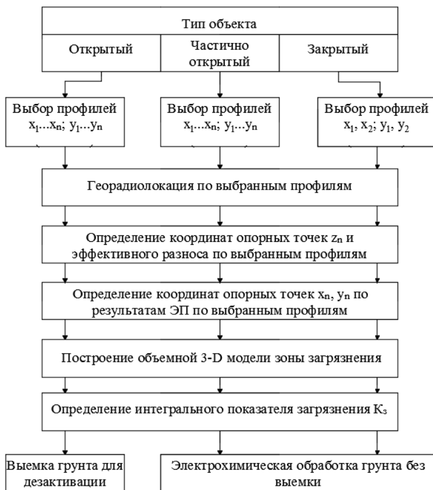
Рис. 3. Алгоритм диагностирования зон нефтезагрязнений
