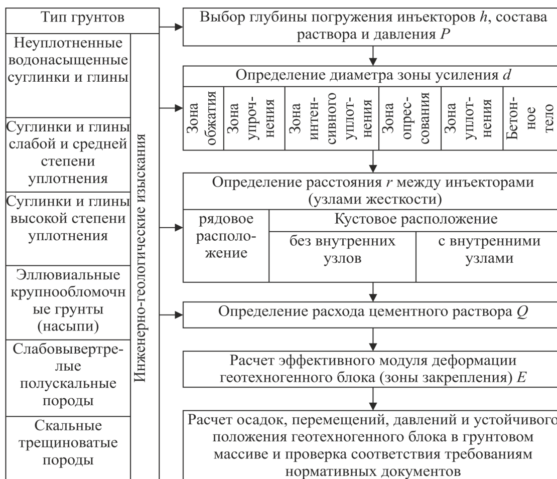
Рис. 2. Алгоритм определения технологических параметров усиления однородного грунтового основания методом геотехногенных блоков (базовой технологией укрепления)
