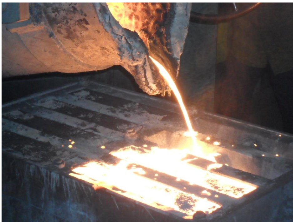
Рисунок № 2 Заливка чушек низкосернистого чугуна
