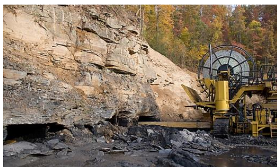
Рис. 3 - Комплекс глубокой разработки пластов на открытых горных работах фирмы Caterpillar Hw300
