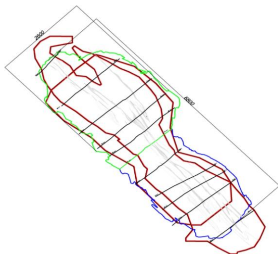
Рис.1. Разработка карьерного поля блоковым порядком.
