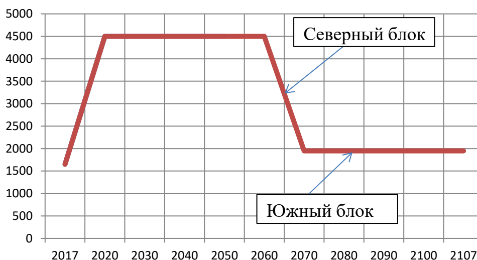
Рис. 3. Календарный график добычных работ по блокам (тыс.т./год).
