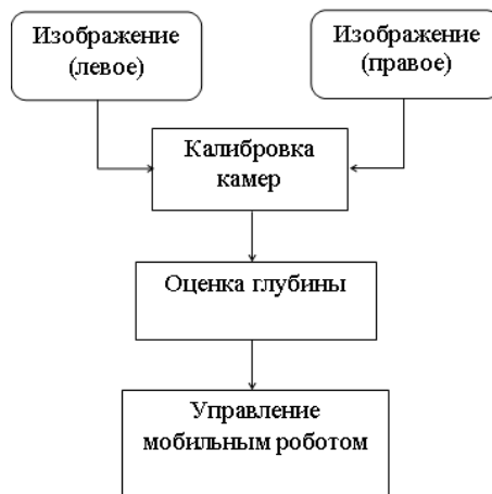
Рис. 4. Структурная схема проектируемой бинокулярной системы
