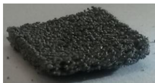
Figure 12. Внешний вид объемного образца (x2). Режимы сплавления V=1000 мм/мин, t=26 °C, S=0,1 мм, P=60 Вт толщина приращенных слоев 200 мкм, защитная среда аргон
